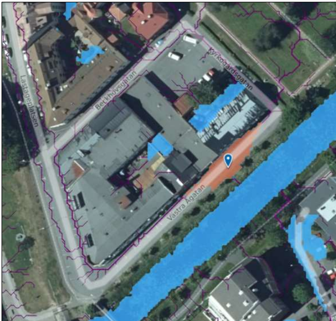
Figur 12. Orange område visar var det ansamlas vatten vid större regn, innan det bräddar ut i Råbelövskanalen (Scalco Live, 2022).
