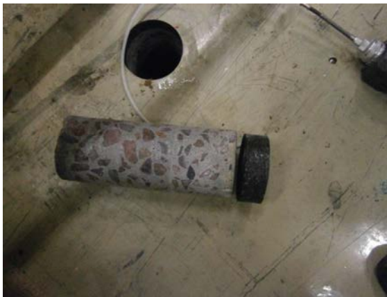
Figur 13. Byggnad 1964 konstruktionsbetong och ovanpåliggande asfaltsbetong. På bilden ses även en gul epoxibeläggning.
