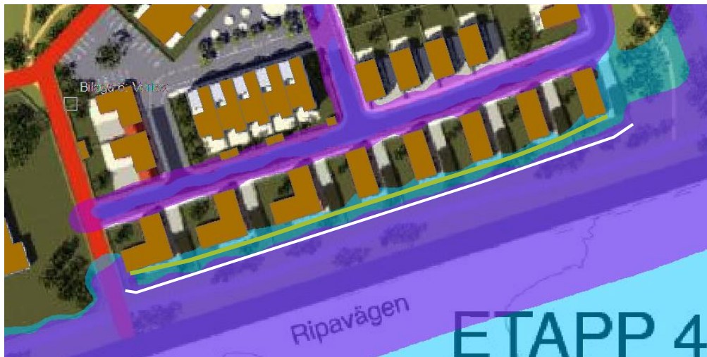
Figur 9. Resultat med bullerskärm i tomtgräns, markerad med vitt streck, för bostadshus i sydöstra delen av planområdet. Höjd på bullerskärm är 1,75 meter ovan vägmitt. Ljudutbredning 2 m ovan mark för ekvivalent ljudnivå över 50 dB(A) (turkos/blå färg) samt maximal ljudnivå över 70 dB(A) (lila färg). Grönt streck avser bedömning av linje från vilken riktvärden ej överskrids för uteplats.
