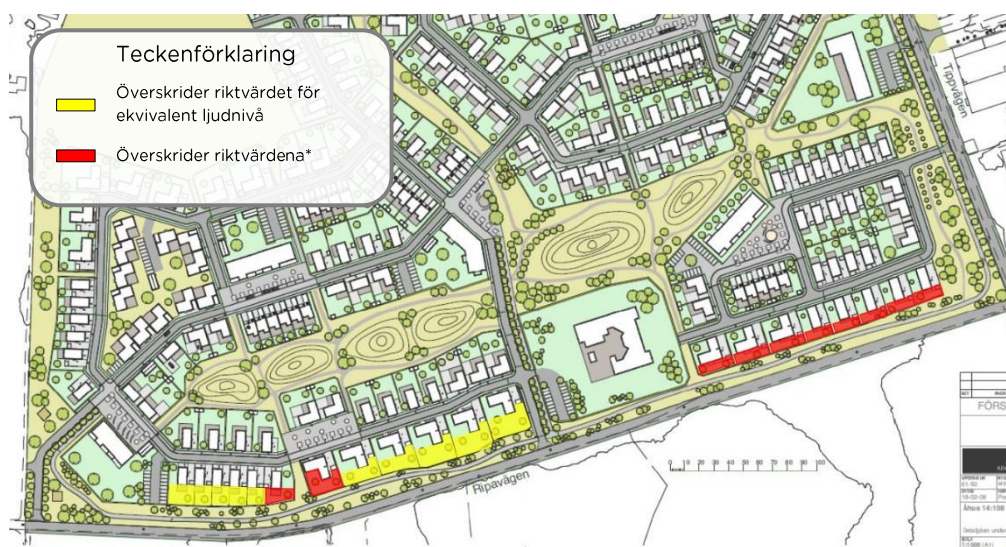
Figur 5. Resultat av bullerberäkningar vid uteplatser. Ytor markerade i figur representerar delar av tomt där riktvärden för uteplats överskrids.
