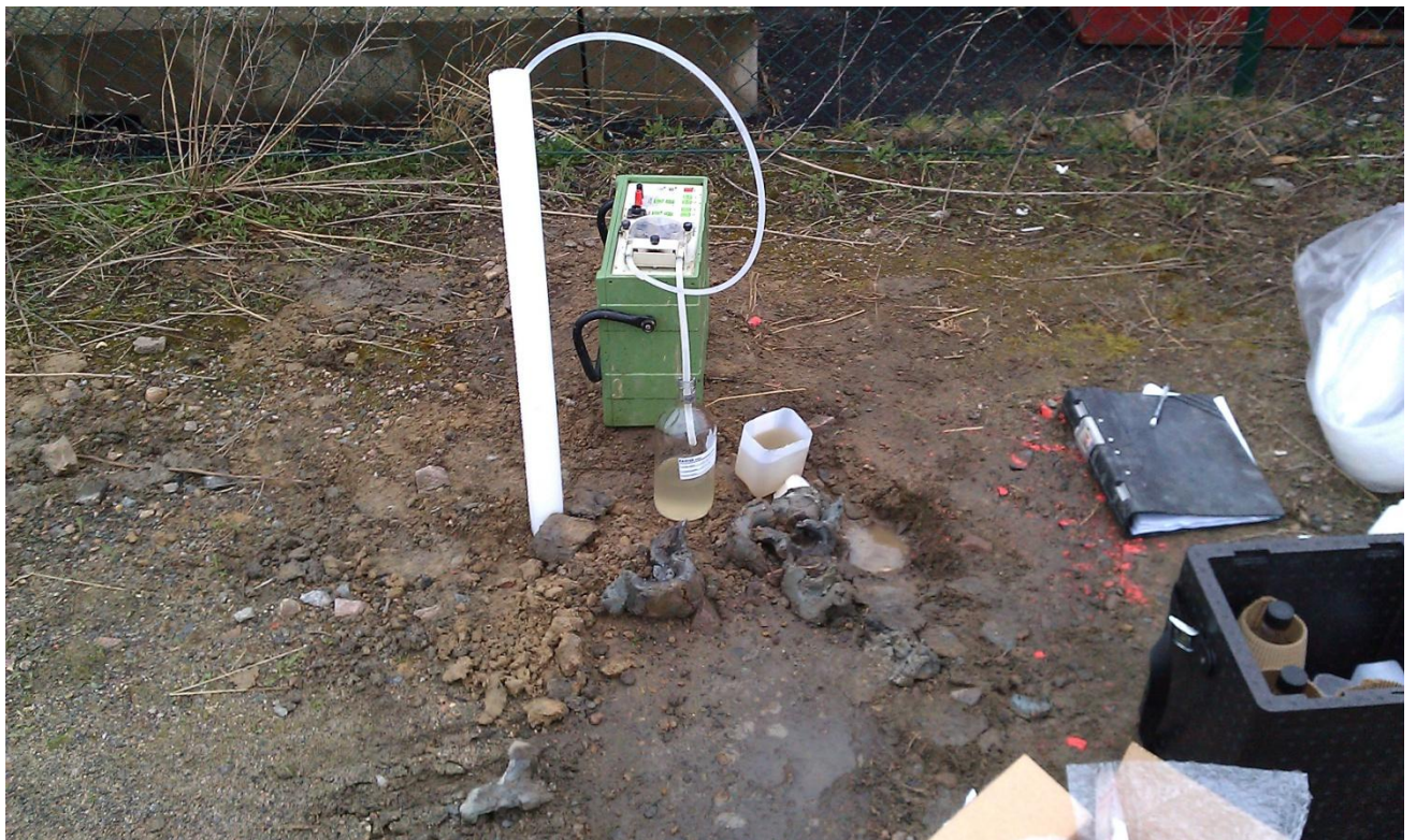
2011-04-06 Grundvattenprovtagnig med peristaltisk pump.
