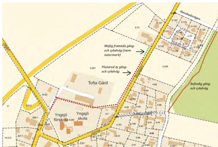
Översiktlig illustration av gång- och cykelvägar i området. Röd streckad linje visar ny planerad gång- och cykelväg, grönstreckad linje markerar den sträcka som planläggs som natur.
