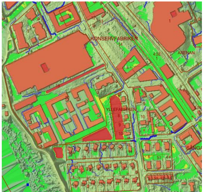
Figur 15. Resultat från simulering av exploatering med skyfallsåtgärder i form av översvämningssytor, grönstråk och justerade vägar. Översvämningssjuka under 20 cm visas i grönt, mellan 20-30 cm visas i gult och över 30 cm visas i rött.
