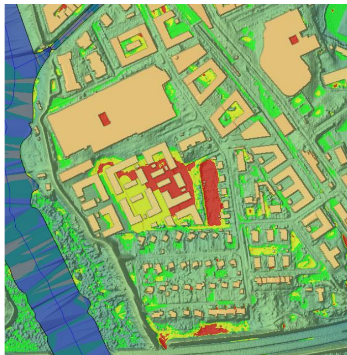
Figur 12. Resultat från simulering av exploatering utan skyfallsåtgärder. Översvämningsdjup under 10 cm visas i grönt, mellan 10-30 cm visas i gult och över 30 cm visas i rött.
