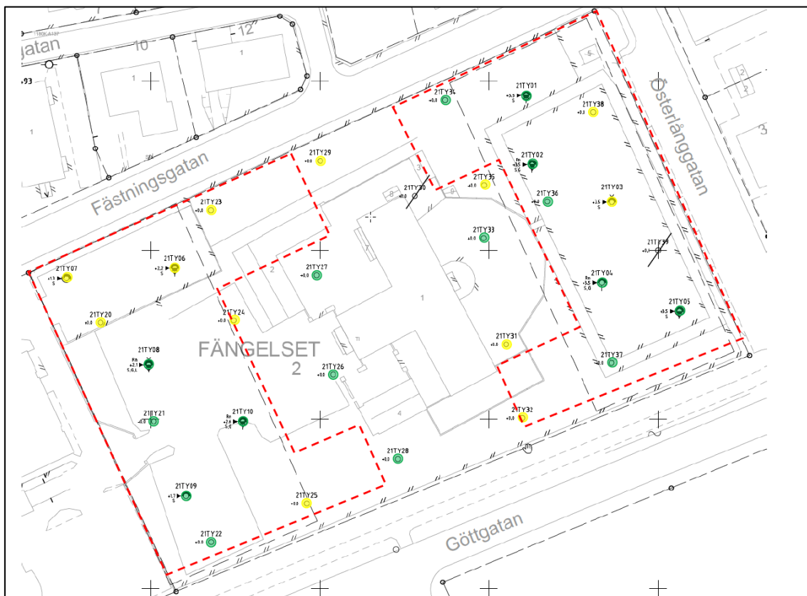
Figur 4. Situationsplan över Fängelset 2 med färgmarkering av påvisade föroreningshalter vid utförda undersökningar 2021. Grön markering visar halt under KM och gul markering visar halt över KM (men under MKM). Av figuren framgår även områden som ska bebyggas med nya byggnader av rödstreckade markeringar.
