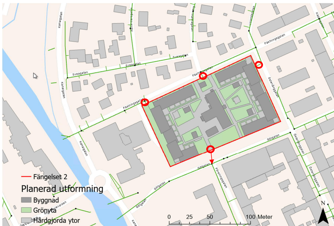
Figur 9 Ledningsnät för dagvatten runt fastigheten. Planerad anslutning till dagvattenledning är markerad med röd cirkel och pil. Befintliga dagvattenserviser belägna i Fästningsgatan och Österlånggatan får enligt VA-huvudman även användas för avvattning.
