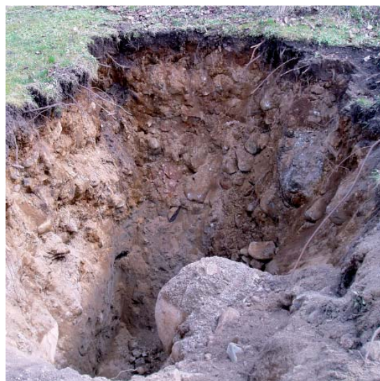
Provgropen visar jordmån och grundvattennivå.
