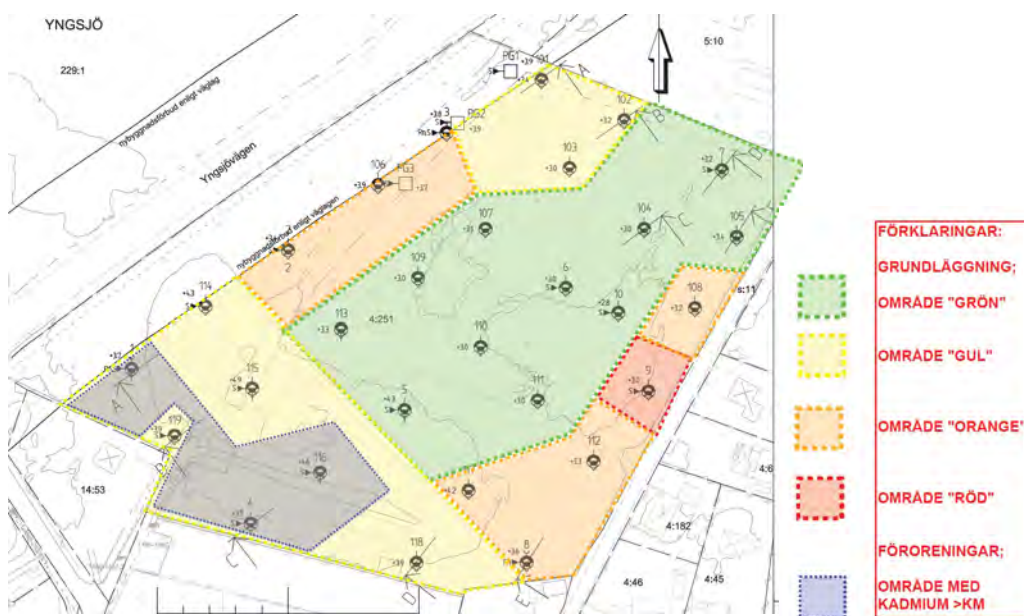
Tolkning av borrhplan, PQ Geoteknik & Miljö AB, 2019-05-08.
