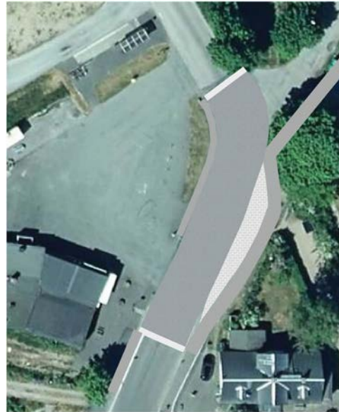
Figur 10 Princip för upphöjning av hela sträckan förbi skolbushållplatsen och planområdets anslutning till Gamla Byvägen. Källa: Google Maps.
