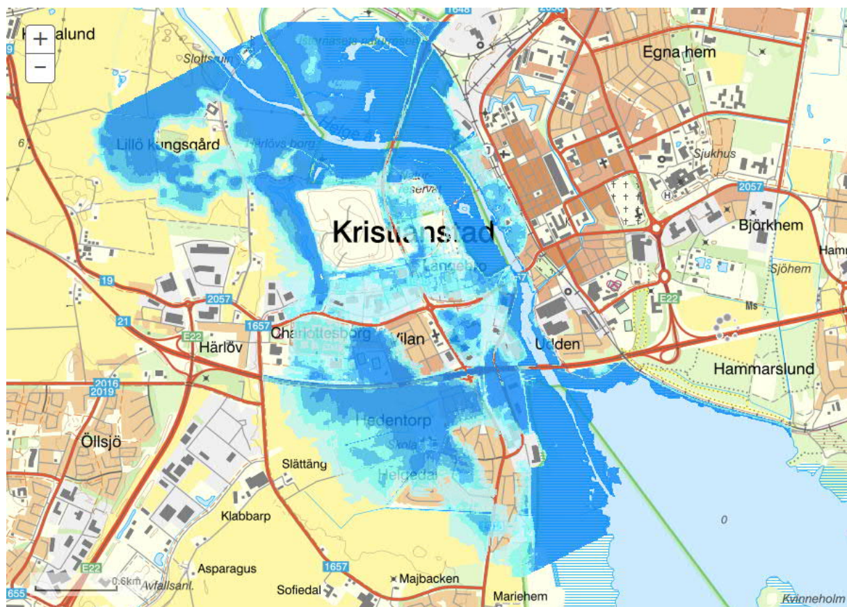
Figur 2 Hot- och riskkarta från MSB, som visar Kristianstad vid ett modellerat 100-årsflöde klimatanpassat flöde för slutet av seklet (Översvänningsportalen. MSB 2023)
