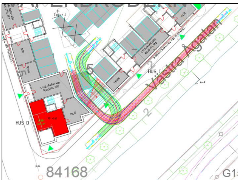
Bild 6. Körspår med personbil vid in- och utfart. Rött körspår ut; grönt körspår in.
