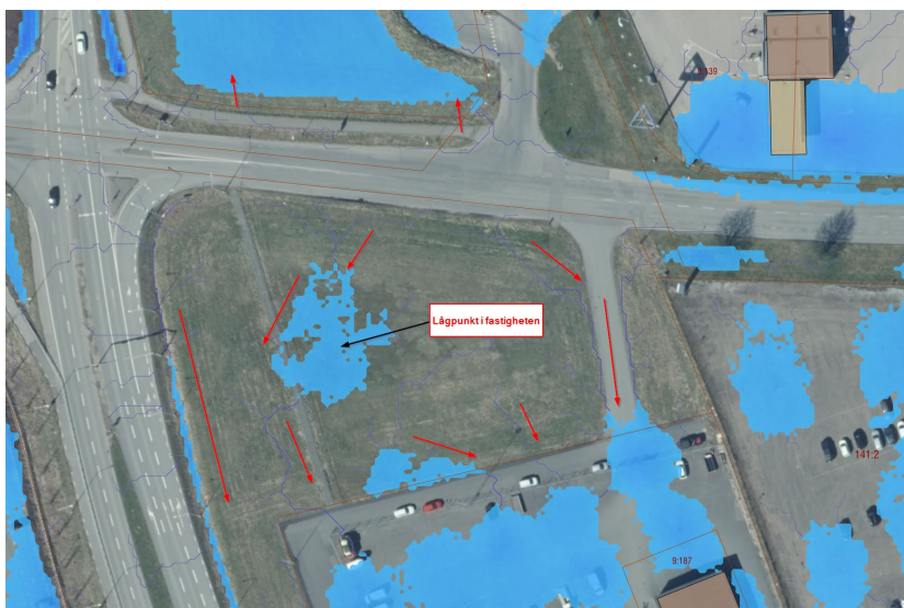
Figur. Resultat från Scalgo. Blå områden visar var det samlas vatten vid skyfall. Röda pilar visar flödesriktning på ytavrinningen. Bild: Tekniska förvaltningen
