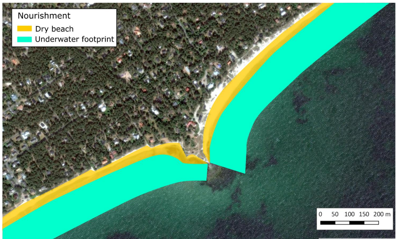
Figur 5.3 Exempel på en storskalig fodring längs med kustlinjen som anpassning till havsnivåhöjning. Fotavtrycket av fodringen är 150 m i detta område och den fodrade volymen är ungefär 150 m 3 /m.
