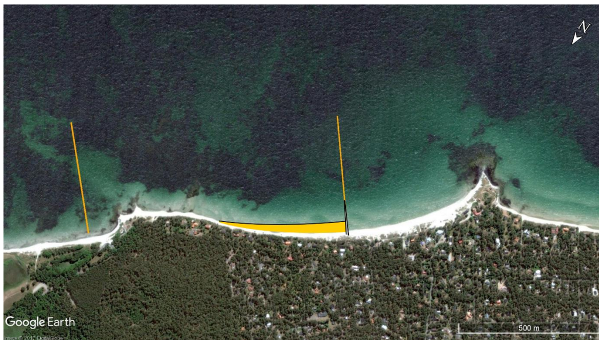
Figur 4.6. Skiss av stödbyggnad som delar upp stranden söder om Snickarhaken i två sektioner. Normalriktningen hos bägge sektioner vänds mot vågorna. Strandfodringen innehåller en volym på ca 45 000 m 3 .
