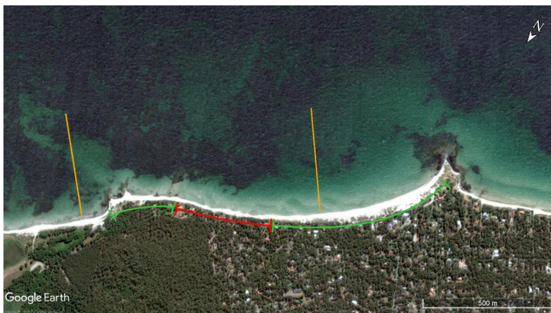
Figur 4.3. Kusten söder om Snickarhaken till Revhaken. Sträckan markerad med den röda linjen är känslig för akut erosion. De gula linjerna anger jämviktsriktningen för kustnormalen. Figur: hämtad från [1].
