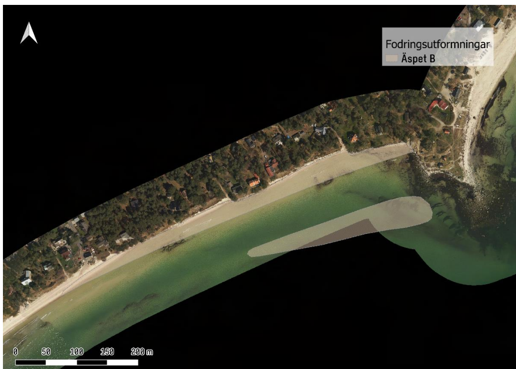
Figur 5-5 Omfattning av strandfodringsförslag "Äspet B". Sandbanken som ses längre ut är tänkt att vara placerad 0,5 m under medelvattenytan.
