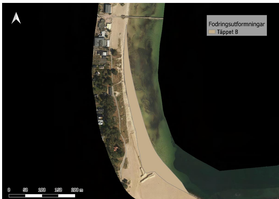
Figur 5-3 Ytlig omfattning av strandfodringsförslag "Täppet B".
