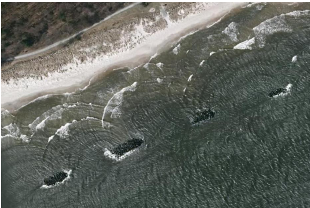
Figur 1-2 Konventionella friliggande vågbrytare i Ystad. På bilden syns tydliga diffraktionsmönster och ett strandplan med våguddar.
