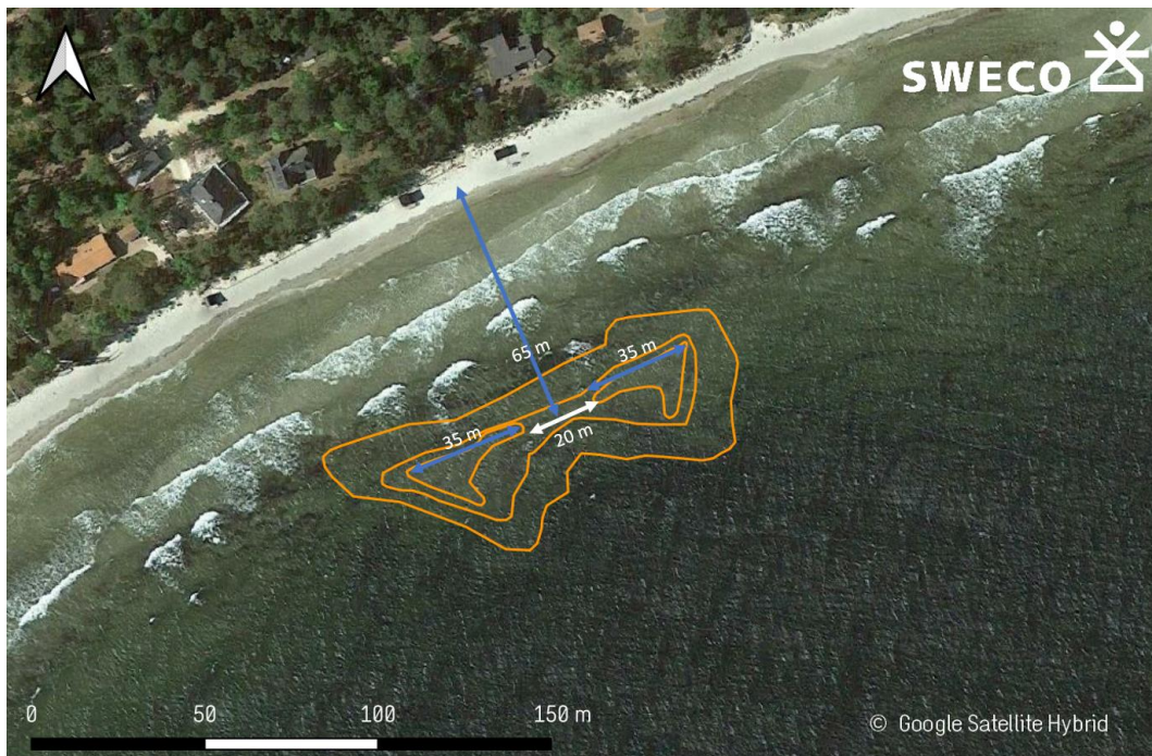
Figur 4-4 Måttangivelser för segmentens längd ( L=35\text{ m} ) och avstånd till strandlinjen ( x=65\text{ m} ).
