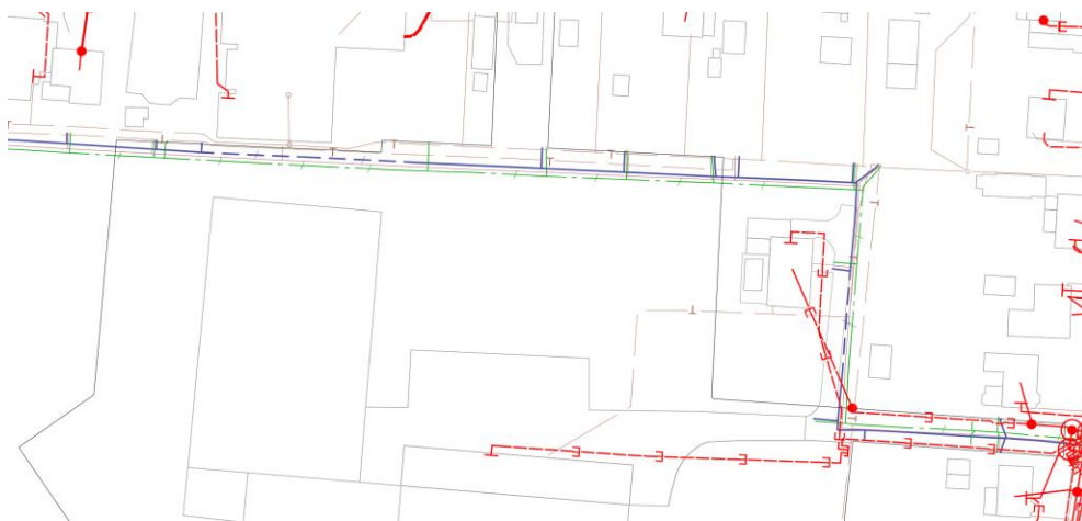
Figur 9 Bef VA-ledningar, el och tele
