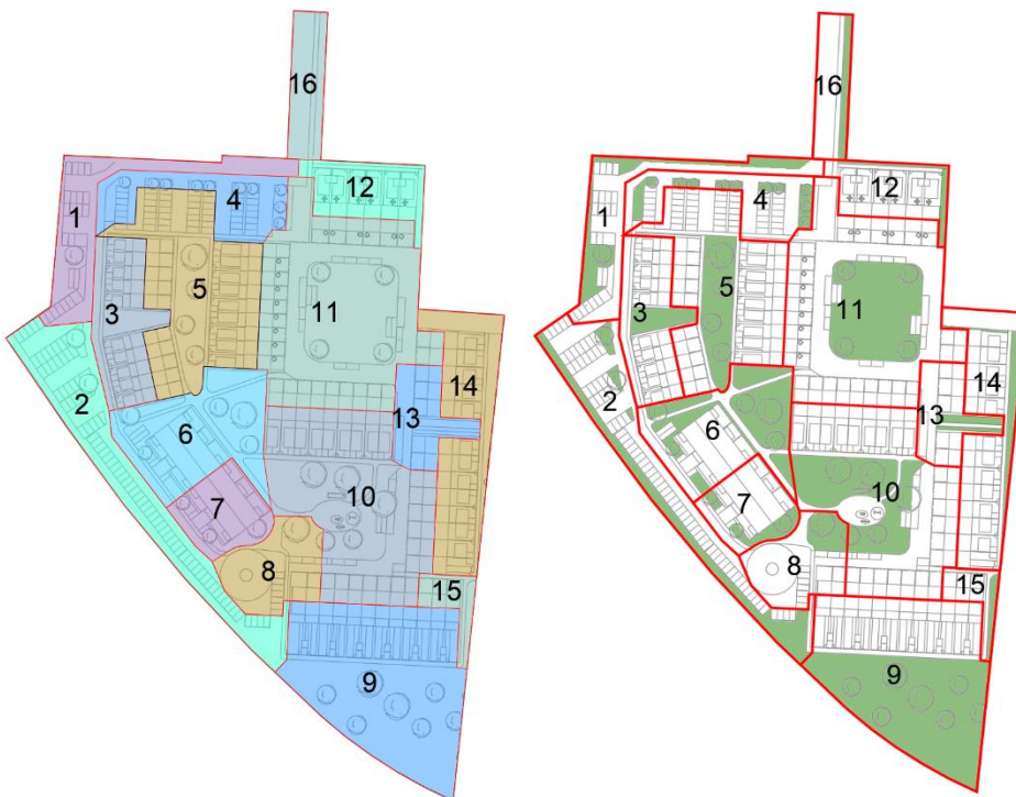
Figur 21 Avrinningsområden och dess respektive grönytor de avrinner till. Avrinningsområden uppskattade baserat på befintliga marknivåer och var det är mest logiskt att dagvattnet kan rinna utan större justeringar av marknivåer
