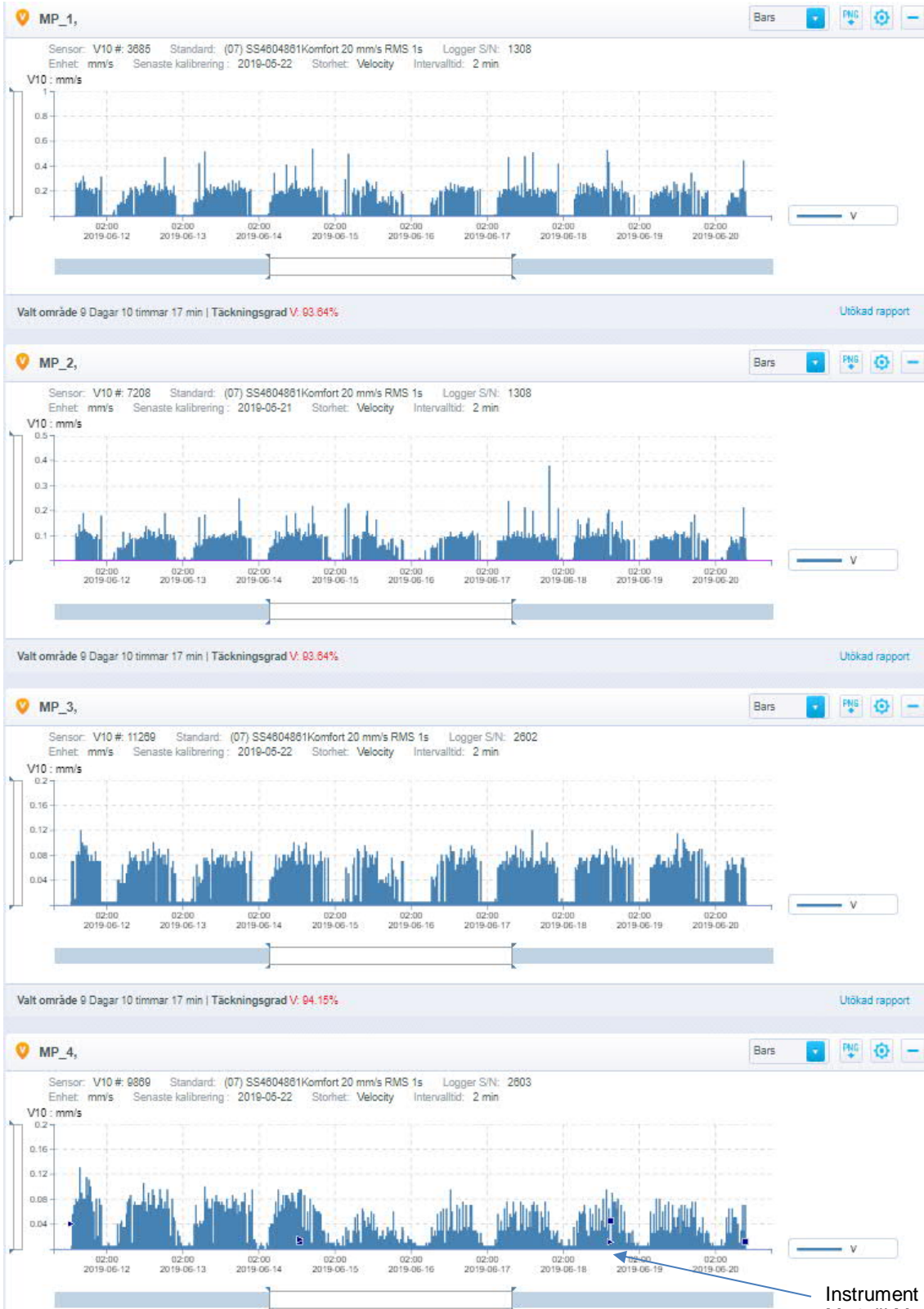
Figur 6. Uppmätta vibrationsnivåer i de fem mätpunkterna (Mp 4 och 5 visas i samma graf)
